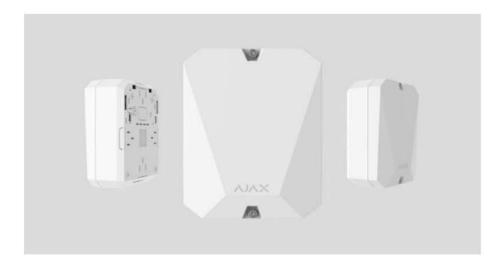
**MultiTransmitter** è un modulo di integrazione con 18 zone cablate per il collegamento di rilevatori di terze parti al sistema di sicurezza Ajax. Per proteggere dallo smantellamento, MultiTransmitter è dotato di due tamponi. È alimentato dalla rete da 100–240 V CA e può funzionare anche con una batteria di backup da 12 V. Può fornire alimentazione a 12 V ai rivelatori collegati.
