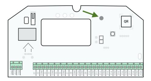
L'indicatore LED del MultiTransmitter potrebbe illuminarsi di bianco, rosso o verde, a seconda dello stato del dispositivo. Si noti che l'indicatore LED non è visibile quando il coperchio del corpo è chiuso, ma lo stato del dispositivo può essere trovato nell'app Ajax.
